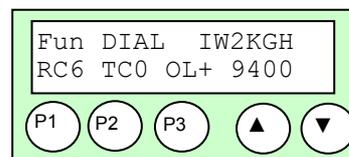
**Regolazione dell'OL:** con il DIAL o PULSANTI ▲▼ impostare la frequenza di OL uguale al convertitore esterno (per variare velocemente il valore di OL, premere e mantenere premuto P2)
