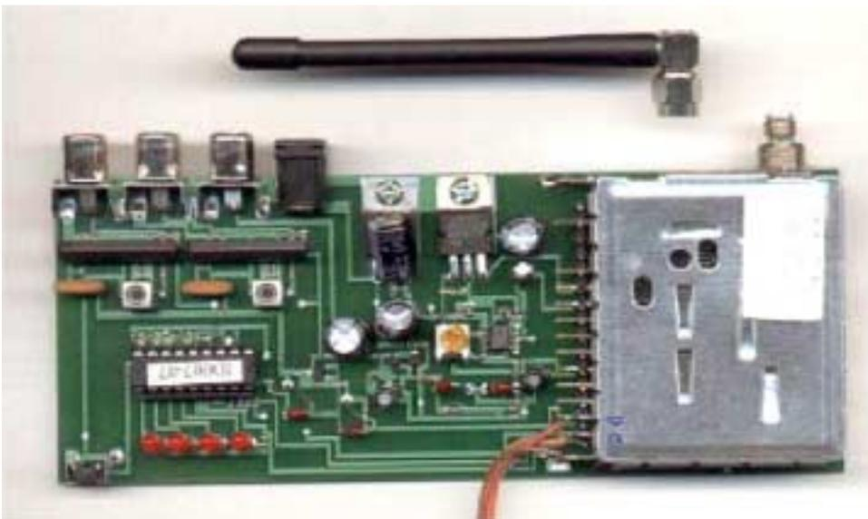
Individuare e dissaldare dallo stampato i 2 Pin SCL/SDA come in figura e connetterli alla linea I2C verso la Interfaccia/Sintonia LCD
